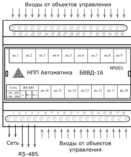
Рисунок 2 - Схема внешних соединений БВВД-16
