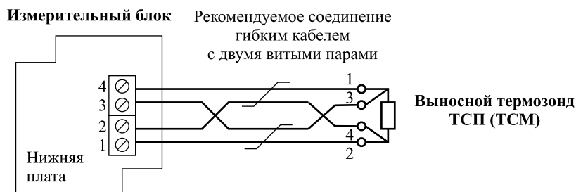
Рисунок 3 - Схема подключения выносного термозонда к ТЦ-1.Б
