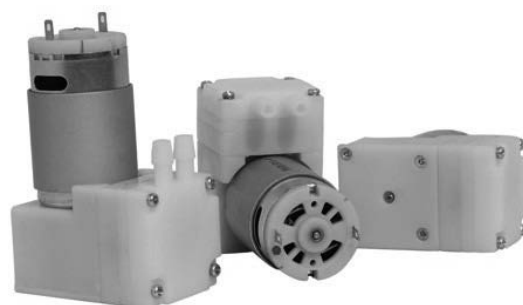
Рисунок А.11 - Компрессор для очистки погружаемых датчиков (12 VDC, 0.6 A, давление до 1,5 бар, расход воздуха до 4 л/мин, габариты 74×51×32 мм)
