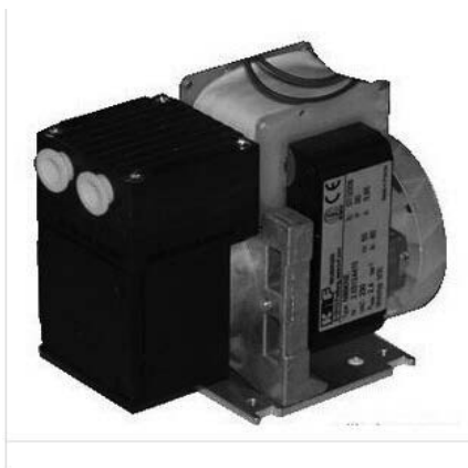
Рисунок А.10 - Компрессор для очистки погружаемых датчиков (~220 VAC, 60 W, давление до 2,4 бар, расход воздуха до 6 л/мин, габариты 103×93×64 мм)
